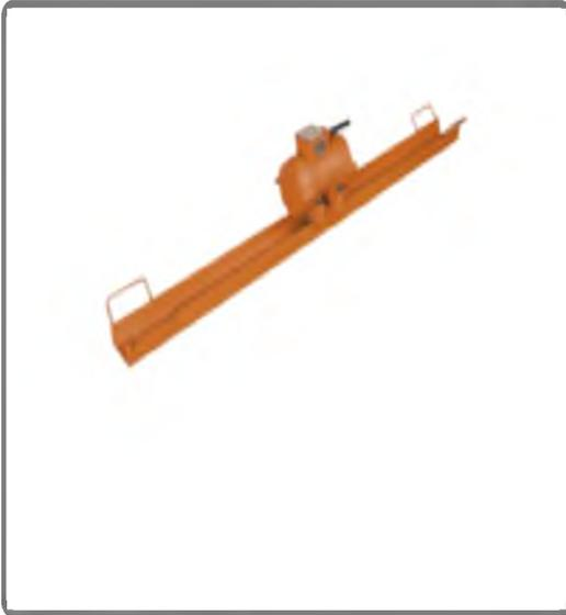
Виброрейки используются в строительной сфере с целью укладки бетона, а также проведения работ по уплотнению и выравниванию стяжек и бетонных полов. Затирочные виброрейки для бетона применяются с целью получения ровных, гладких поверхностей из недавно уложенной бетонной смеси при бетонировании полов, бетонных покрытий, площадок в гражданском и промышленном строительстве.
